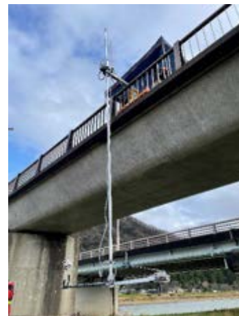
新技術【①橋梁点検支援ロボット(見る診るmini)+橋梁点検調書作成支援システム、 ②MCSによる3Dデータを活用した橋梁点検技術】 を用いた橋梁点検に関する研修(令和5年12月18日開催)
